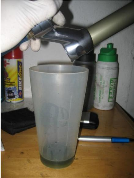
El siguiente paso para concluir con esta pata es desenroscar con una llave fija la parte inferior del hidráulico y extraerlo. Comentar que todas las piezas que vamos retirando las vamos limpiando cuidadosamente con papel de cocina o un trapo limpio, aunque podemos observar que tras dos temporadas de uso de la horquilla en competición principalmente, apenas hay suciedad en el interior de la misma lo que habla muy bien de su construcción.
