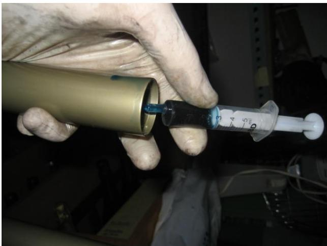
Montamos la parte inferior del hidráulico y para facilitar el montaje damos un poco de aire a la horquilla para que se extienda la misma. Para facilitar el trabajo, ya podemos montar las barras en las botellas, sin olvidar introducir el aceite de baño abierto (16-20 cc) en el interior de cada pata.
