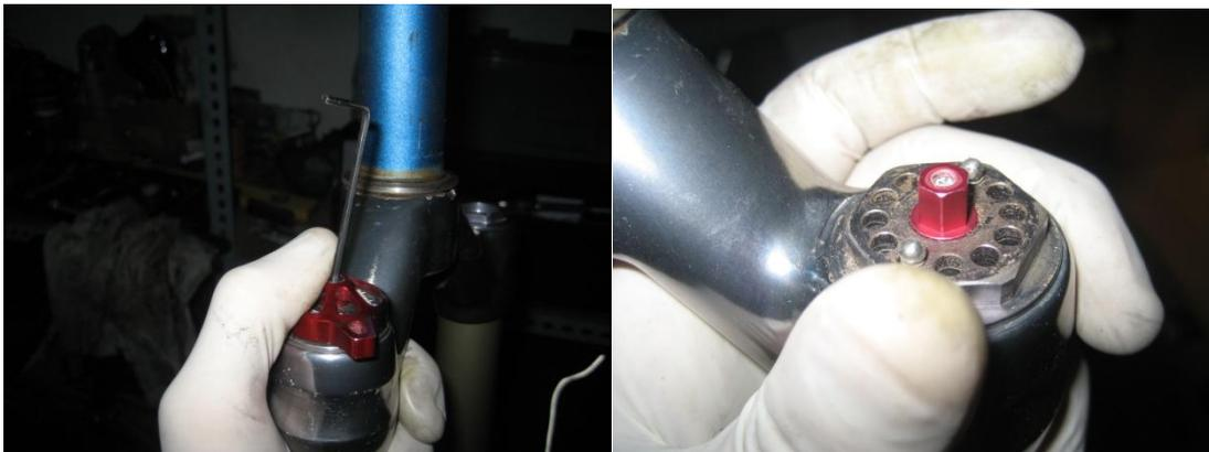
Continuamos el proceso desmontando la parte superior del hidráulico con una llave fija. Lo extraemos y vaciamos el aceite del mismo, bombeando la parte inferior para asegurarnos de que salga todo.
