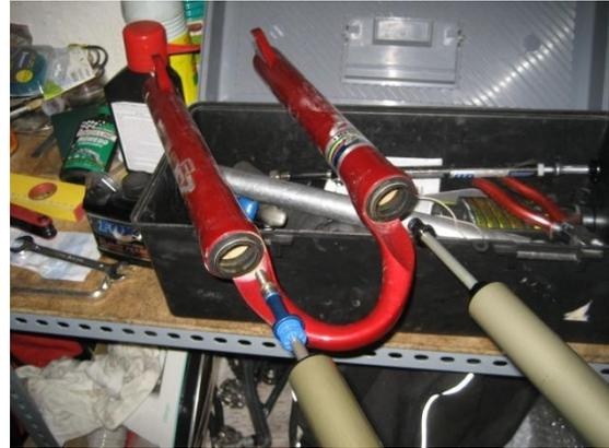
Comenzamos desmontando el dial de regulación de la plataforma estable Absolute. Simplemente desenroscando el tornillo de la parte superior con una llave allen. Retiramos con cuidado el dial y debajo nos encontramos un par de pequeñas bolitas situadas sobre muelles, responsables del funcionamiento suave de esta regulación. Retiramos con cuidado las bolitas y los muelles para evitar perderlos.
